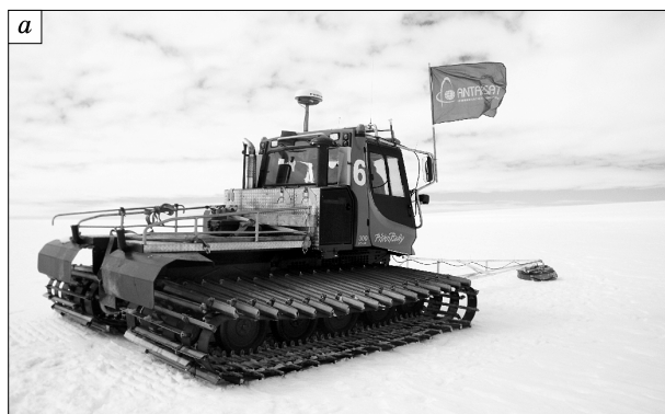
Рис. 6. Приспособления, предназначенные для дистанционного обнаружения приповерхностных трещин в теле ледника с помощью георадаров на станции Прогресс.
