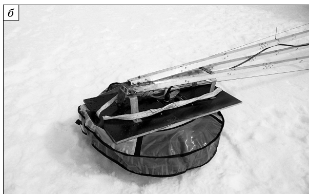
Рис. 6. Приспособления, предназначенные для дистанционного обнаружения приповерхностных трещин в теле ледника с помощью георадаров на станции Прогресс.
