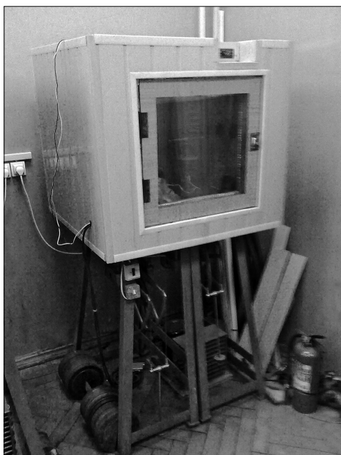
Рис. 1. Холодильный шкаф с установками одноосного сжатия.
