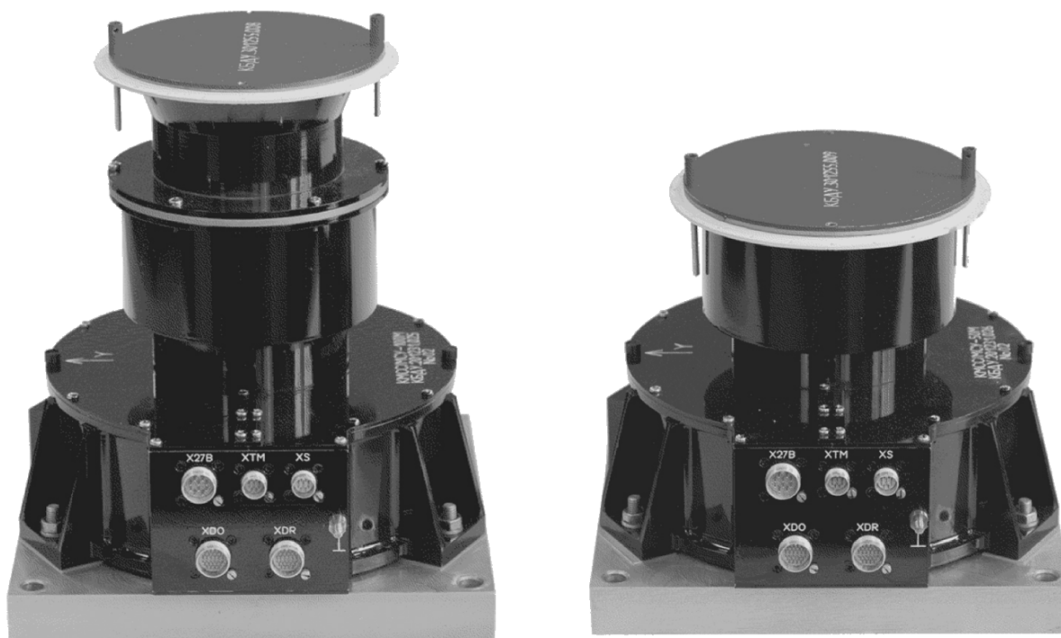
Рис. 2. Внешний вид камер КМСС: слева – MSU-100; справа – MSU-50.
