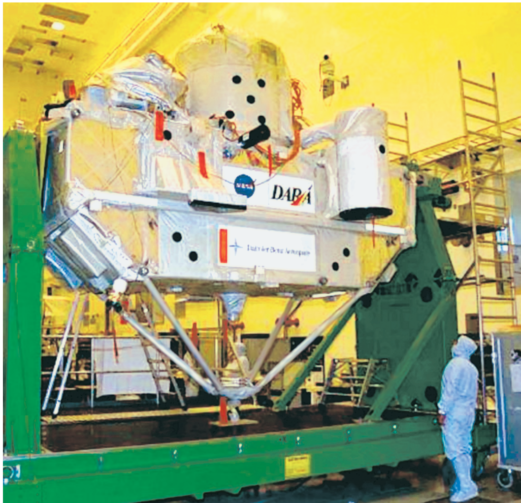
Сборка комплекса аппаратуры "КРИСТА" на платформе-носителе "КРИСТА-СПАС" в Центре пилотируемых космических полетов им. Л. Джонсона (штат Флорида). Фото NASA.
