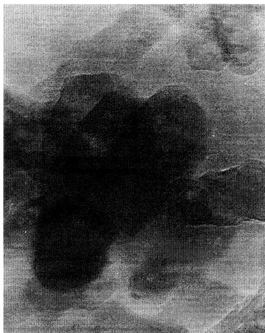
Рис. 1. Единичные кристаллы ГАП в исходной суспензии ( \times 3 \times 10^6 ). Изображение получено в университете Лозанны на микроскопе CM-300 Philips по методике [13].
