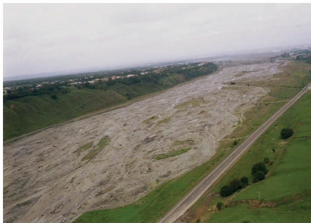
Рис. 5. Нижняя часть зоны распада низкоплотного селя водно-ледово-грязевого состава. Примечательным 21–22.09.2002 г. было наличие на поверхности ярко белых глыб (до 0.5 м в поперечнике) высокогорного снега — фирна. На высокой террасе левого борта долины — с. Верхняя Саниба, на заднем плане, на правом берегу — с. Гизель. (Фото Г.А. Долгова, полдень 21.09.2002 г.)
