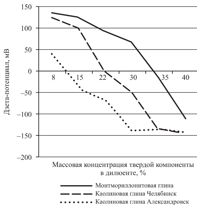
Рис. 4. Изменения дзета-потенциала в зависимости от содержания твердой компоненты глин в дизельном топливе.
