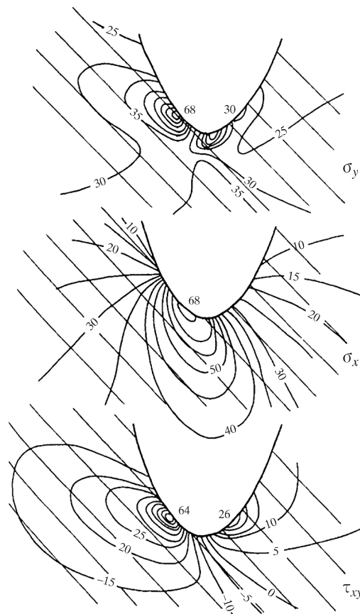
Рис. 9. Распределение напряжений (МПа) в склонах долины, заложенной в наклонно залегающем анизотропном массиве (угол наклона слоев 45°).
