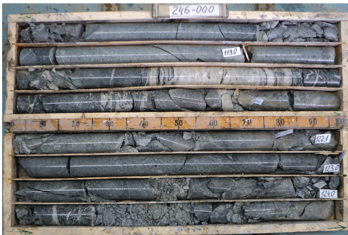
Рис. 5. Окварцевание (осветление) по интенсивно гидрослюдизированным (темное) околожильным игнимбритам риодацита в керне скважин: а – 254-035W (интервал 39.6–47.2 м) и б – 246-000 (интервал 117.5–124.9 м) операции 2013 г. Отмечается перекристаллизация вдоль ранних трещин, осветление, образования монолита по катаклазированной ранее породе. Метасоматиты с трудом царапаются стальной иглой, без выделения белого порошка.
