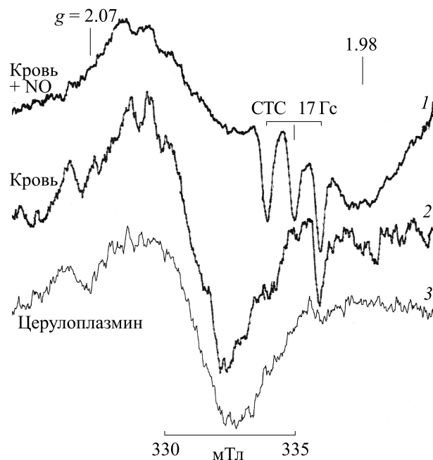
Рис. 3. Спектры ЭПР крови здоровой лошади (спектр 2), крови, обработанной газообразным оксидом азота (спектр 1), и церулоплазмину (спектр 3). Кровь здоровой лошади содержит нитрозогемоглобин в количестве 0.2 \pm 0.5 мкМ; кровь, обработанная оксидом азота, – 12,3 \pm 0,3 мкМ. Условия регистрации, как указано выше. Спектр 1: усиление 2 \cdot 10^5 , 4 скана; спектр 2 – 1 \cdot 10^5 , 1 скан. T = 77 К.
