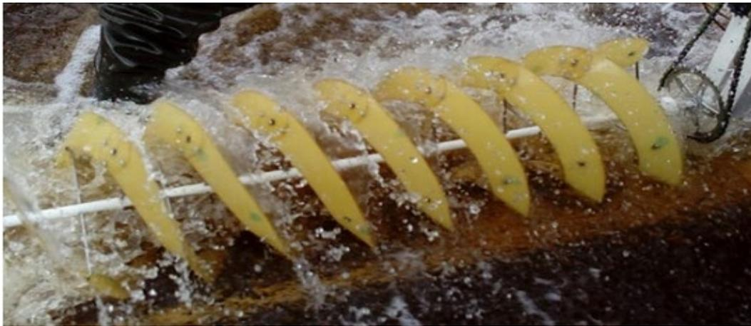
Рис.8. Безнапорная шнековая мини ГЭС УрФУ.
