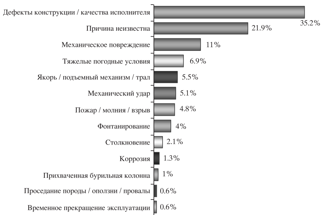
Рис. 3. Влияние различных факторов на возникновение аварийных ситуаций на морских нефтегазовых разработках Европы (по [4]).
