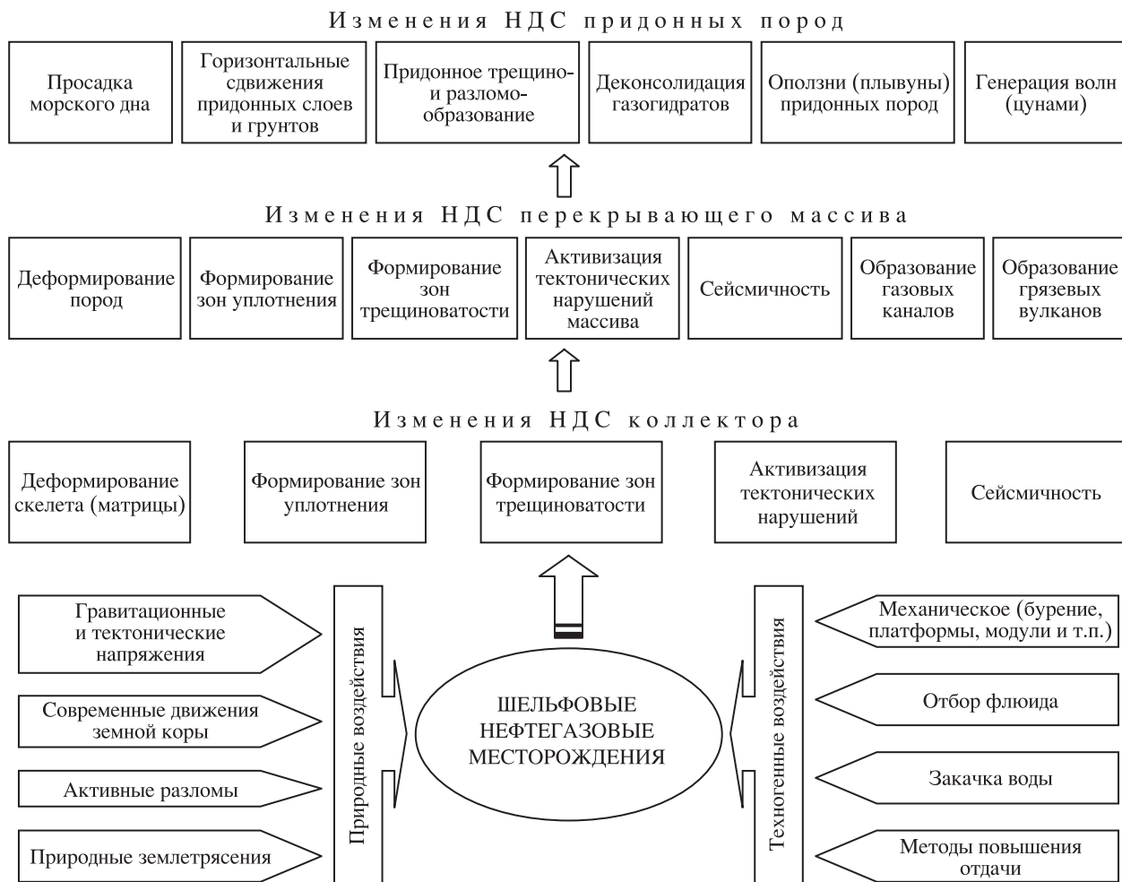
Рис. 1. Воздействие на шельфовое нефтегазовое месторождение и результирующие геомеханические процессы и геодинамические проявления. НДС – напряженно-деформированное состояние.
