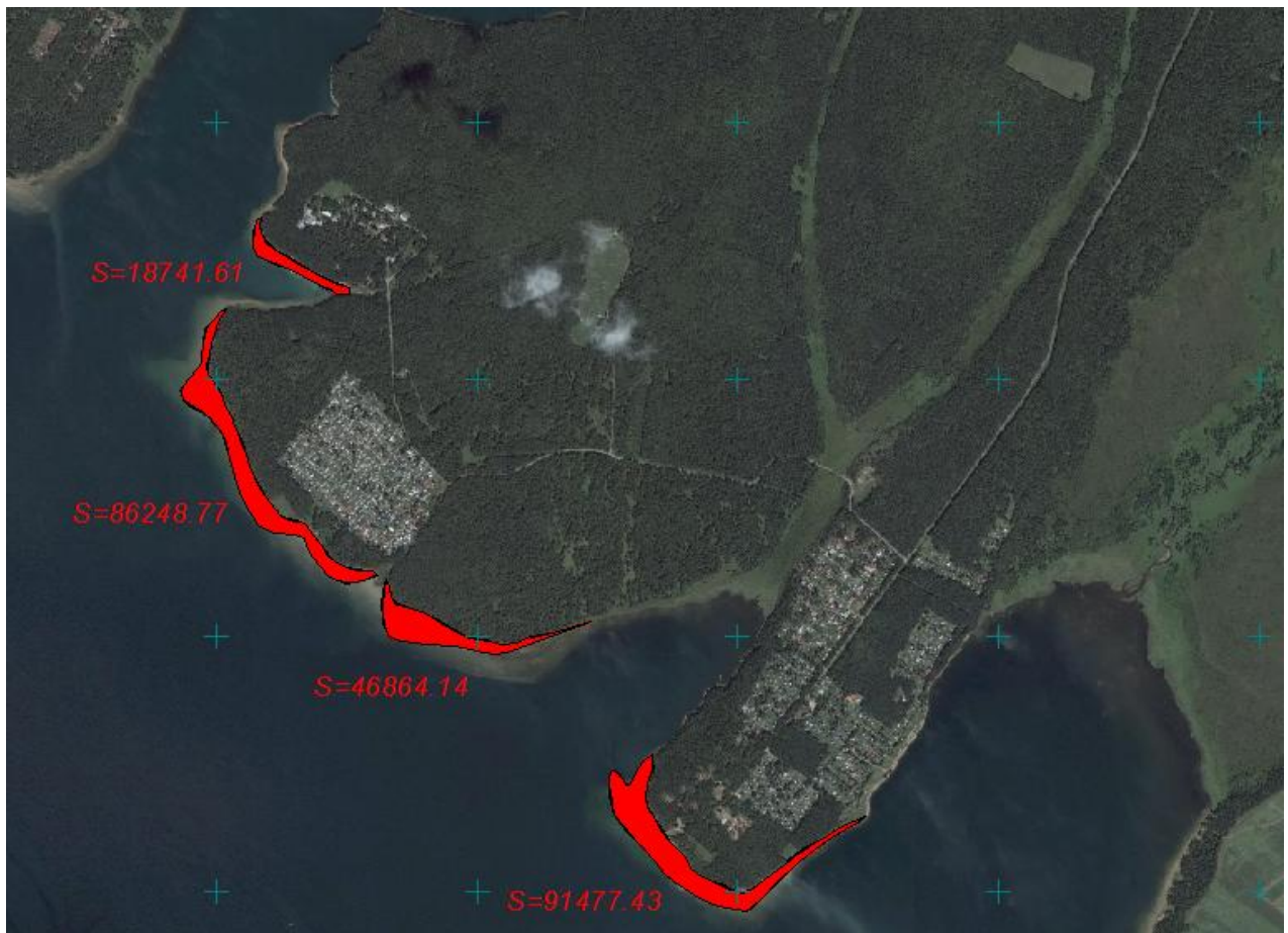
Рис. 4.10.7. Сопоставление спутникового снимка участка Иркутского водохранилища 2009 г. и топографической карты 1962 года. Площадь размыва берегов в районе п. Зеленый Мыс 151854,52 м 2 , в районе поселка Южный 91477,43 м 2 .
