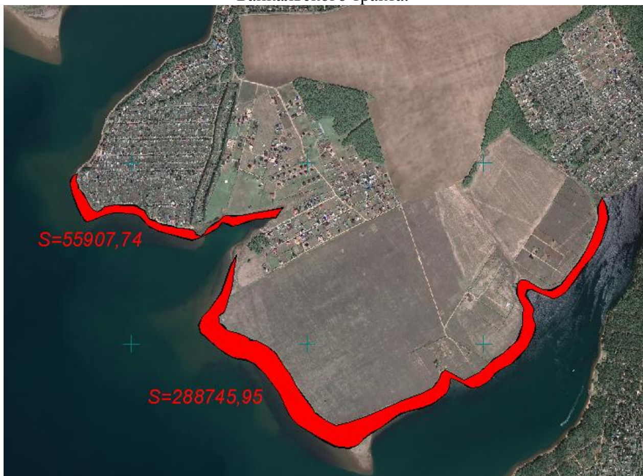
Рис. 4.10.8. Сопоставление спутникового снимка участка Иркутского водохранилища 2009 г. и топографической карты 1962 года. Площадь размыва берегов в районе 15 км. 344653,69 м 2 .
