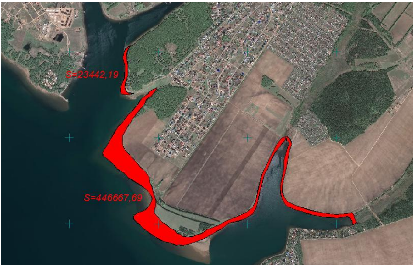
Рис. 4.10.6. Сопоставление спутникового снимка участка Иркутского водохранилища 2009 г. и топографической карты 1962 года. Площадь размыва берегов в районе п. Молодежный 470109,88 м 2 .
