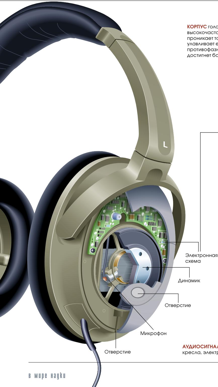
**КОРПУС** головного телефона и уплотняющее кольцо ослабляют высокочастотный шум, и в переднюю раковину наушника проникает только низкочастотная составляющая. Микрофон улавливает ее, и электронная схема заставляет динамик излучать противофазные волны, подавляющие шум еще до того, как он достигнет барабанной перепонки.
