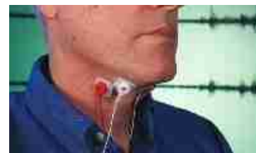
«Подслушанные» мысли: сенсоры, расположенные близ голосовых связок и языка, и специальная компьютерная программа улавливают и распознают слова, беззвучно произносимые людьми.
