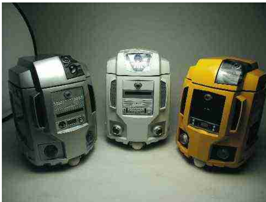
УНИВЕРСАЛЬНУЮ МОБИЛЬНУЮ платформу можно оснастить различными комплектующими и превратить базовую модель 912 (слева) в видеомузыкальный центр 912 MP3 (посередине) или в чуткого сторожа 912 HNV (справа).
