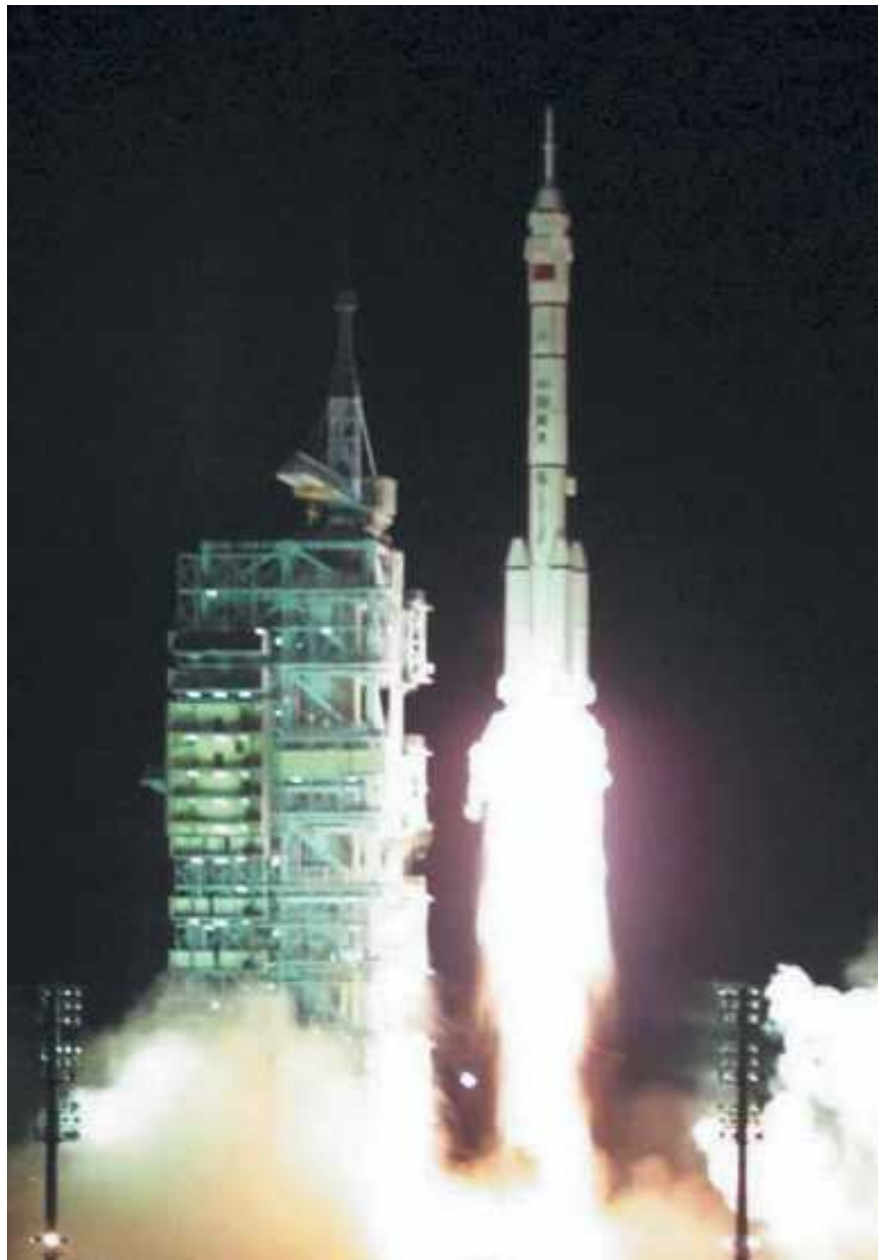
Испытательный непилотируемый полет «Шэньчжоу-2» начался с ночного запуска 10 января 2001 г. Двухступенчатая ракета «Чанчжен 2F» получает дополнительный импульс от четырех сбрасываемых бустеров, расположенных в ее нижней части.
