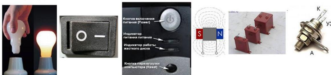
Рис. 1.1. Примеры бистабильных систем, пригодных для побитового хранения данных: лампа (горит-не горит), выключатель (включено-выключено), конденсатор (заряжено-разряжено) и т.д.
