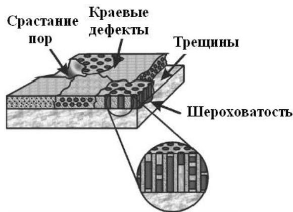
*Рис. 11.5. Схема мезопористой тонкой пленки анодированного оксида алюминия. Стрелками обозначены дефекты структуры пленки*
