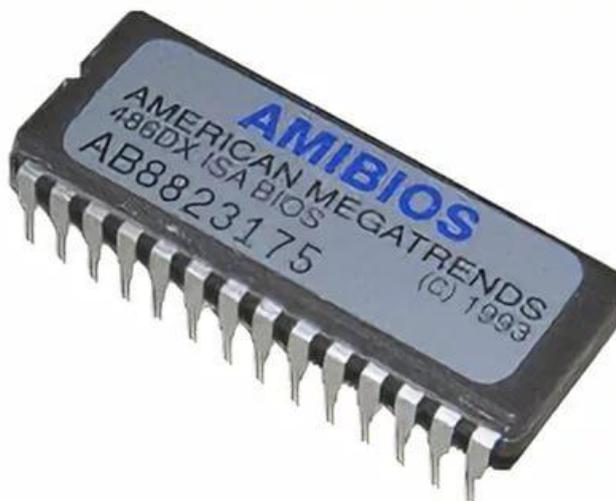
Рис. 3.1. Внешний вид постоянного запоминающего устройства
