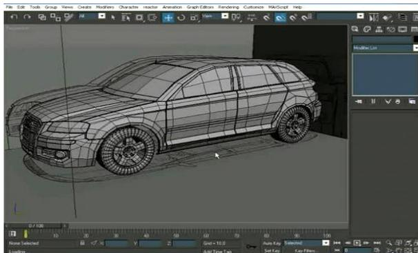
Рис. 8.1. Пример моделирования кузова автомобиля с помощью специализированных программных средств
