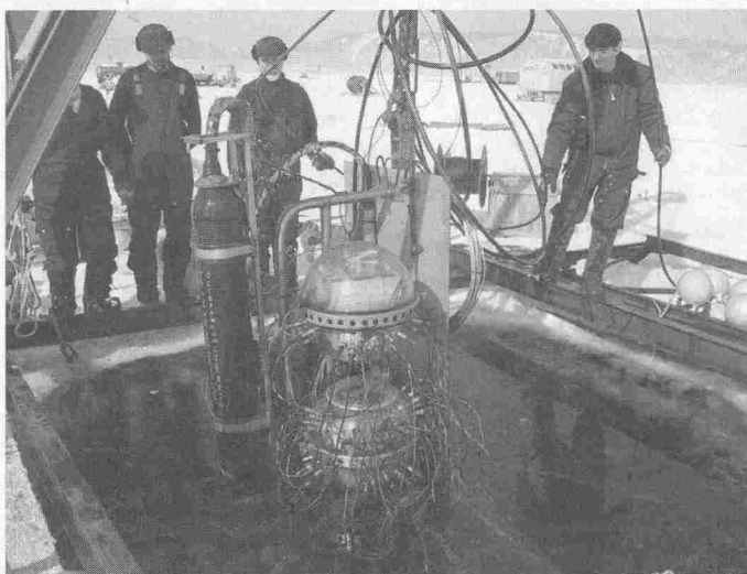
Центральный узел электроники Байкальского нейтринного телескопа
