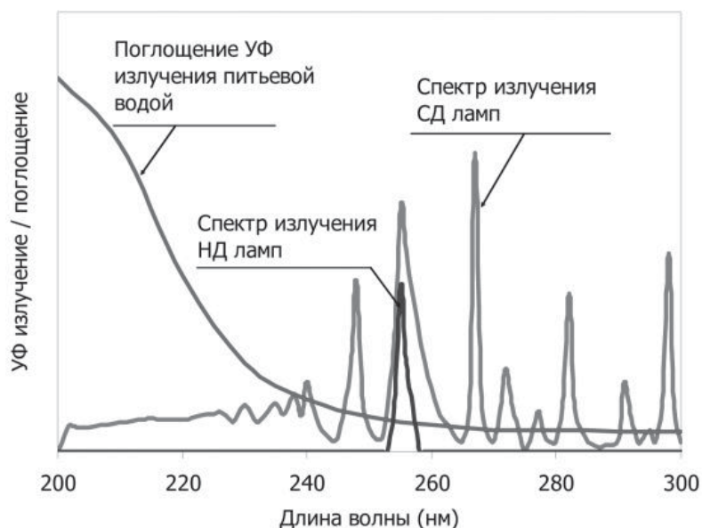
Рис. 2. Спектр излучения монохроматических и полихроматических ламп и поглощения УФ излучения водой питьевого качества.
