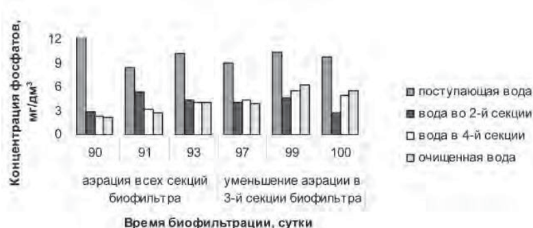
Рис. 5. Кинетика концентрации фосфатов в процессе биофильтрации сточной воды при различных режимах аэрации.
