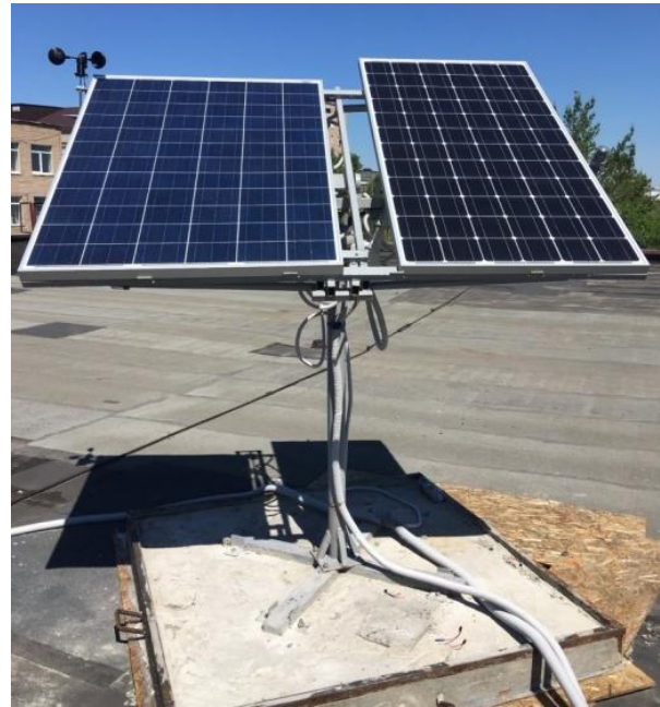
Рис. 2 – Общий вид автоматизированного двухкоординатного солнечного трекера Fig. 2 – General view of the automated dual-axis solar tracker
