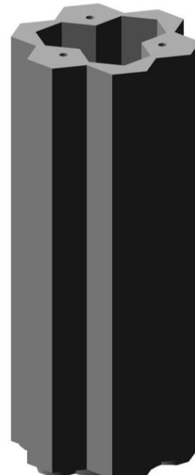
Рис. 1 – Облучательное устройство
