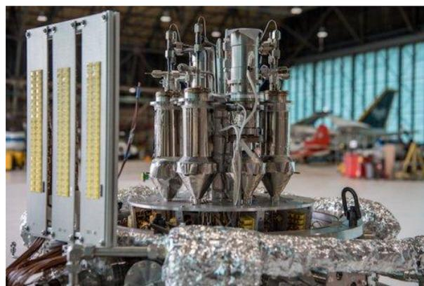
В марте этого года исследовательская группа провела испытания, во время которых реактор Kilopower работал на полной мощности в течение 20 часов. Данный реактор еще не предназначен для запуска в космос, тем не менее его испытания проводились в условиях, которые максимально близко приближены к реальным условиям в космосе.
