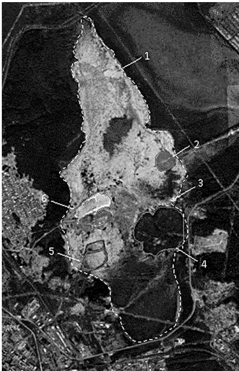
Рис. 1. Схема размещения отходов на болоте Конинник. 1 — границы болота, 2 — свалка древесных отходов, 3 — выпуск очистных сооружений, 4 — свалка гидролизного лигнина, 5 — отвал золы ТЭС, 6 — свалка отходов лесопиления (топографическая основа Яндекс Карты [2]).
