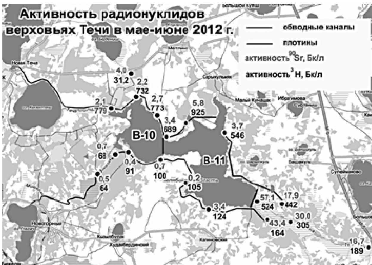
Рис. 1. Удельная активность ^{90}\text{Sr} и ^3\text{H} в пробах воды в обводных каналах и реке Теча.
