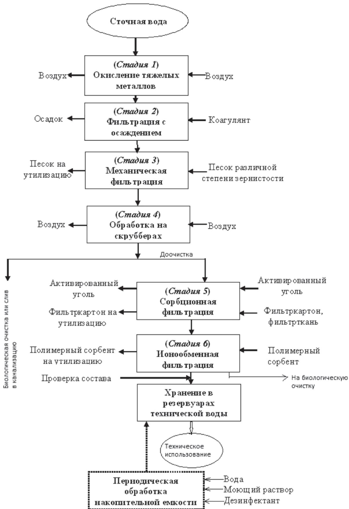
Рис. 1. Блок-схема водоочистки с частичным технологическим водооборотом.
