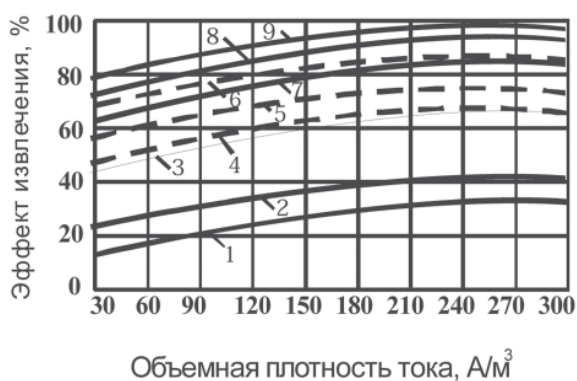
Рис. 4. Влияние объемной плотности тока на эффект извлечения бензинов марок АИ-93 (1,4,7), АИ-95 (2,5,8) и дизтоплива (3,6,9) при электрокоагуляции ионами алюминия дозой 50 мг/л и продолжительности электрофлотации, мин: 1,2,3-2; 4,5,6-5; 7,8,9-12
