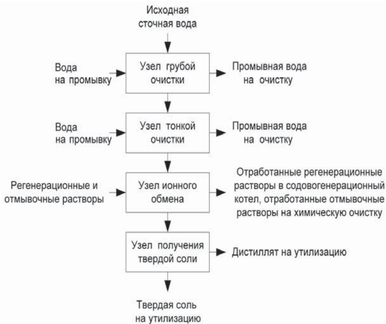
Рис. 3. Принципиальная схема очистки сточных вод на основе ионного обмена.
