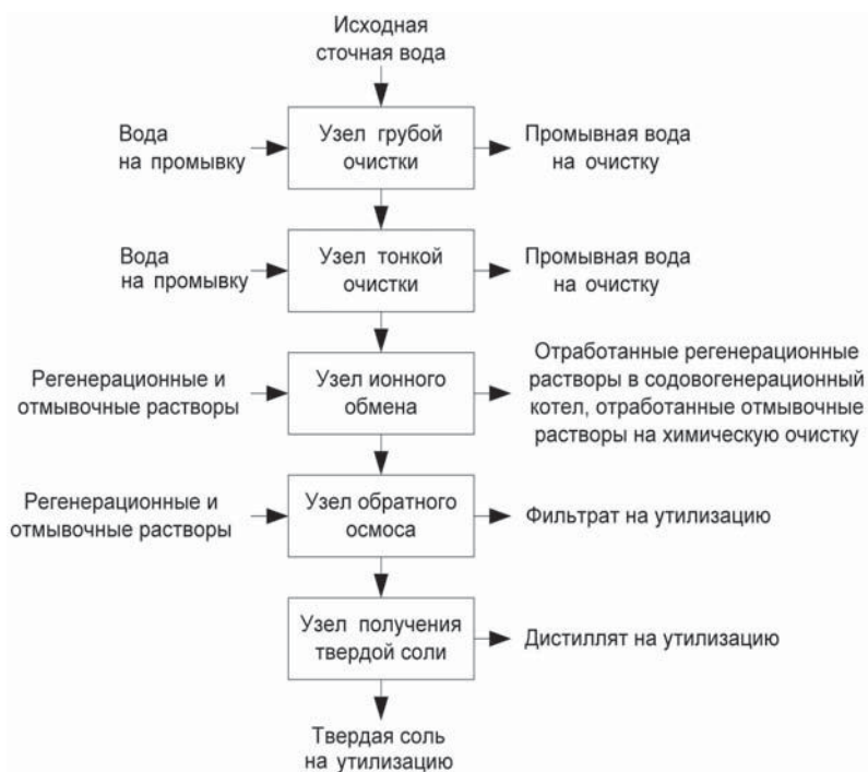
Рис. 1. Принципиальная схема очистки сточных вод на основе метода обратного осмоса.
