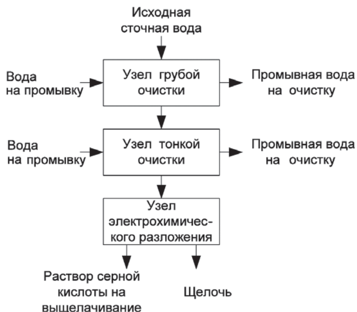
Рис. 6. Принципиальная схема очистки сточных вод на основе электрохимического разложения.
