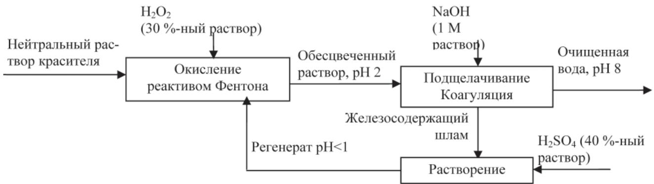
**Рис. 3.** Организация процесса регенерации железосодержащих шламов.
