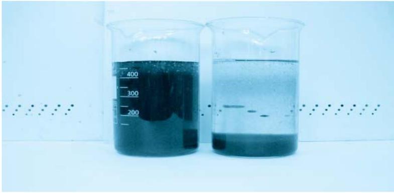
**Рис. 11.** Внешний вид воды, содержащий зеленый краситель (570мг/л), до и после коагуляции ОХА-Н при рН 5,4. Доза 400 мг/л.
