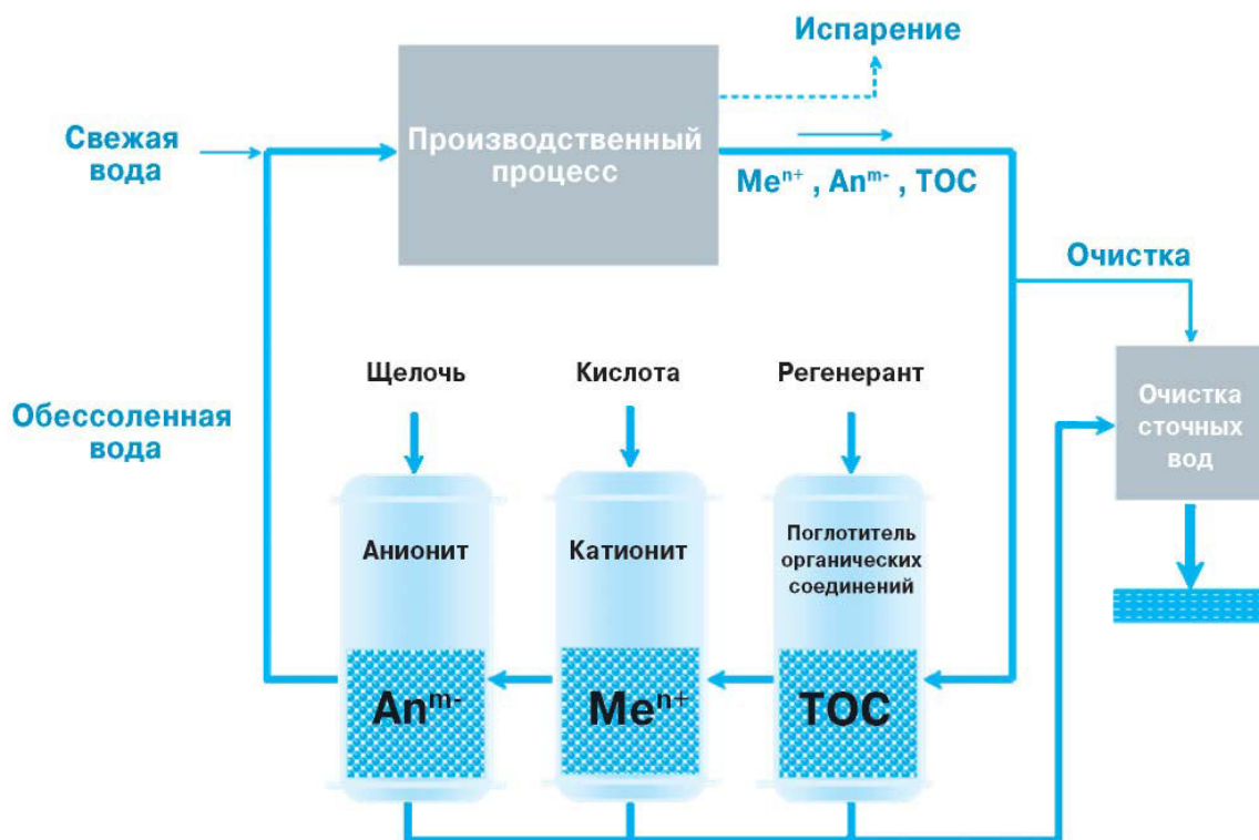
Рис. 4. Схема процесса рециркуляции воды.
