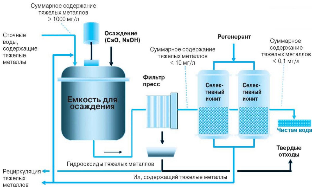
Рис. 3. Схема очистки сильнозагрязненных сточных вод.
