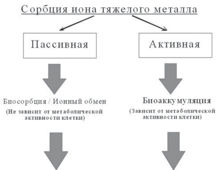
Рис. 1. Схема осуществления сорбции ионов тяжелых металлов дрожжами.
