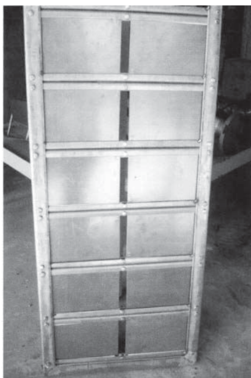
Рис 2. Внешний вид кассеты для экспозиции образцов на морском испытательном стенде.
