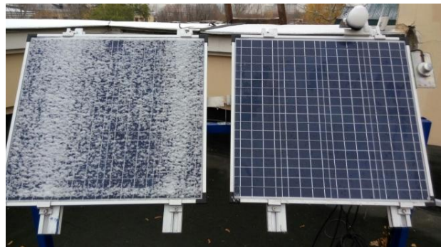
Рис. 12 – Экспериментальная установка при оснежении одного ФЭП Fig. 12 – Experimental setup for snowfall of a single PV
