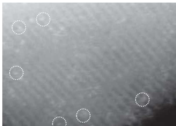
Атомная структура катализатора \text{CeO}_2/\text{Pt} , полученная с помощью просвечивающей электронной микроскопии.
