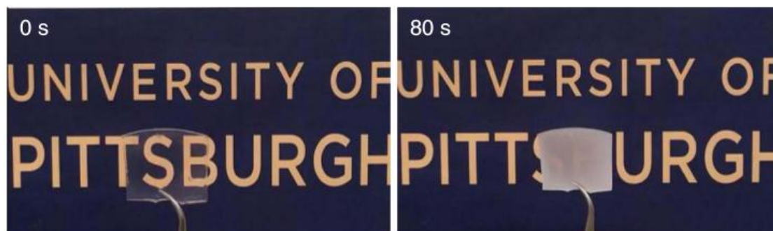
Стекло, покрытое нанотравой длиной 6 микрон, сразу после смачивания водой и через 80 секунд, когда вся вода с поверхности испарилась. S. Haghaniyar et al./ Optica, 2017
