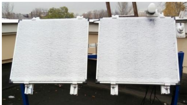
Рис. 8 – Экспериментальная установка при загрязнении (снег) обоих ФЭП
