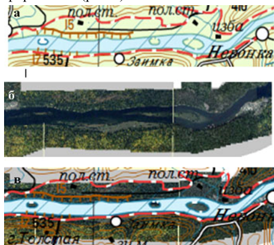
Рис. 3 – Пример совмещения разных информационных слоев: а) фрагмент топографической карты масштаба 1:1 000 000; б) космическое изображение ИСЗ Landsat-7, 2014 г.; в) комбинированное изображение
