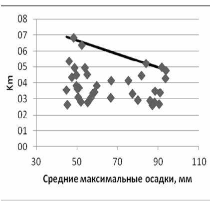
Рис. 2 – Зависимость коэффициента Km от среднееголетнего максимума суточных осадков для Приморья и её верхняя огибающая
