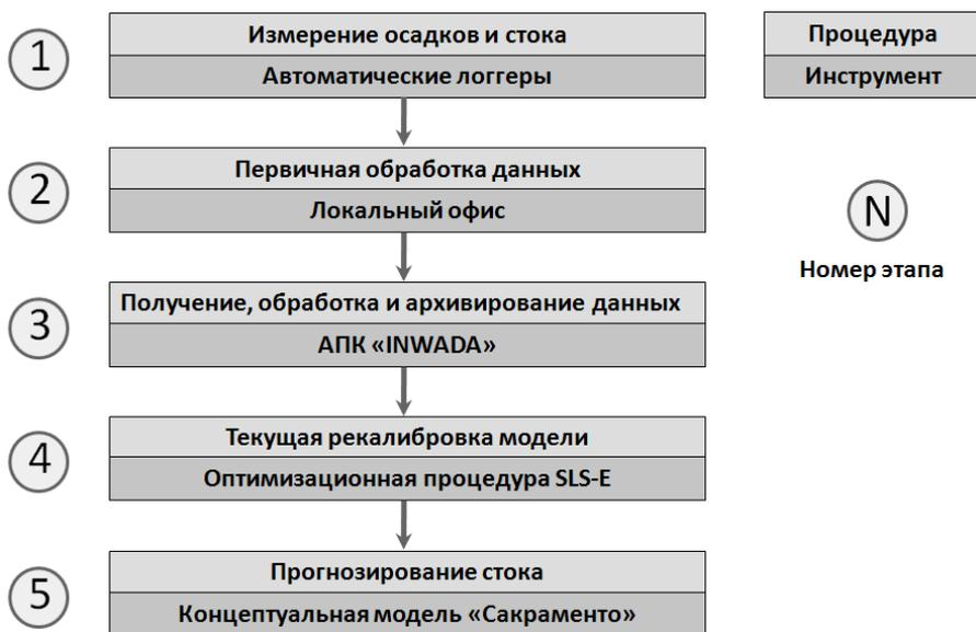
Рис. 1 – Принципиальная схема системы фонового прогнозирования стока
