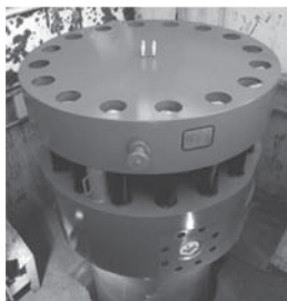
Рис. 2 Тест-камера высокого давления для имитации глубин океана до 9000 м в Южном отделении ИО РАН (модернизирована специалистами службы гипербарического комплекса под руководством О.Н. Скалацкого)
