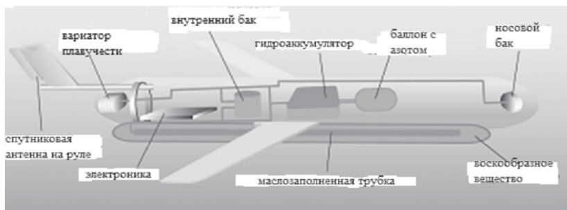
Рис. 2. Устройство подводного глайдера «SLOCUM»
