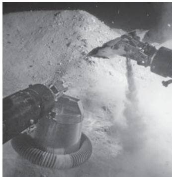
Рис. 1. Схема негерметичного контейнера слева, и фото загрузки контейнера ГГ на дне Байкала
