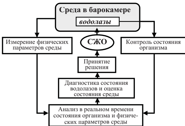
Рис. 2. Схема управления гипербарической средой по отклонению физических и физиологических параметров
