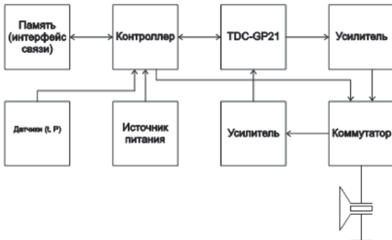
Рис. 1. Структурно-функциональная схема измерителя скорости звука
