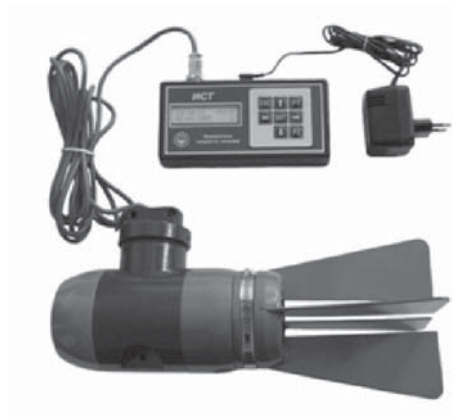
Рис. 1. Внешний вид погружного и бортового блоков прибора ИСТ-1
