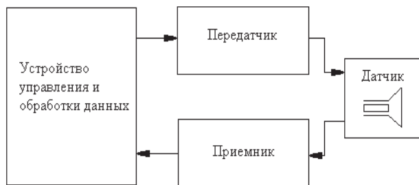
Рис. 2. Обобщенная структурная схема акустического волнографа
