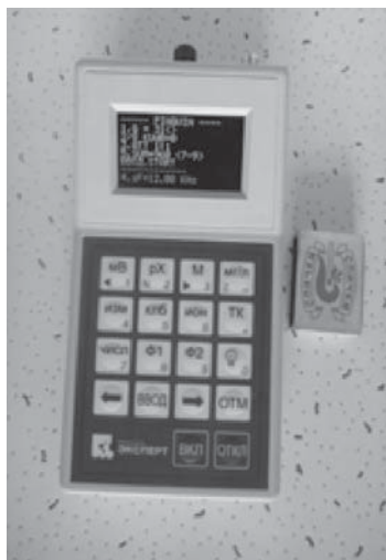
Рис. 2. Новейшая версия устройства синхронизации и оцифровки Лаборатории акустики океана
