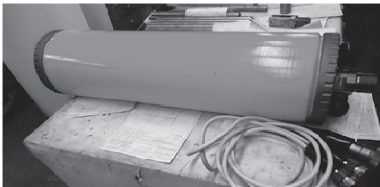
Рис. 10. Широкополосный автономный донный сейсмограф ИО РАН для станции со стабилизированным трансляционным буем
