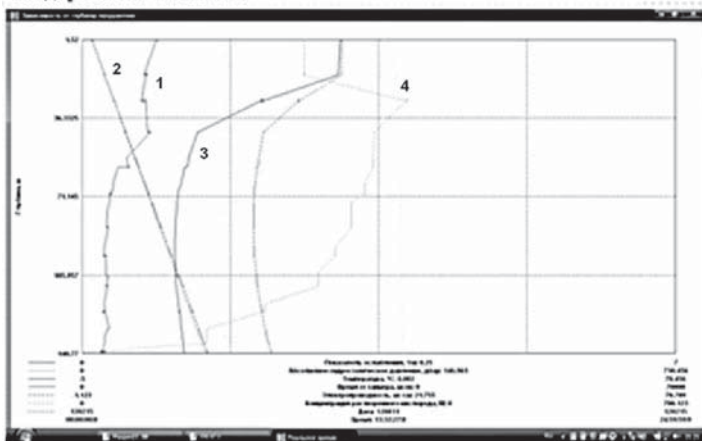
Рис. 5. Результаты зондирования измерительным комплексом до глубины 120 м 12.08.2012 г. 1 – показатель ослабления направленного света; 2 – гидростатическое давление; 3 – температура; 4 – концентрация растворенного кислорода
