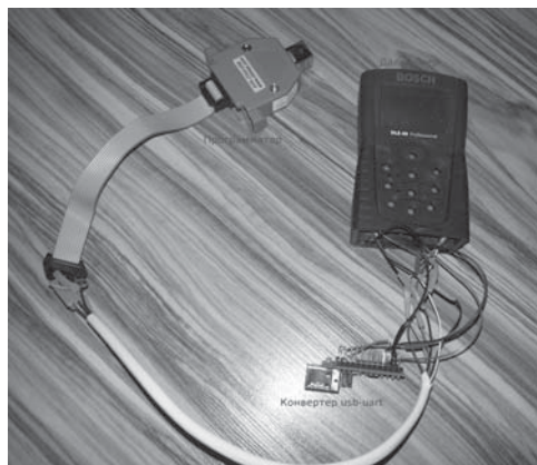
Рис. 1. Сборка и подключения на воздухе лазерного дальнометра, конвертера usb-uart и программатора
