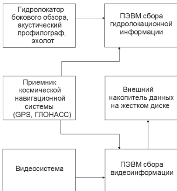
Рис. 1. Функциональная схема системы сбора гидролокационной информации с параллельной видеосъемкой структур берегового рельефа
