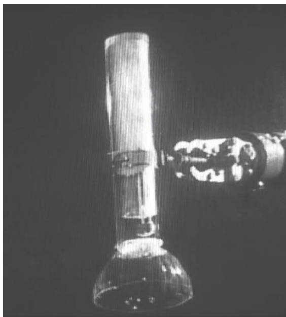
Рис. 2. Контейнер «Термо» с гидратной пеной. Диаметр цилиндрической части 70 мм. Внутри закреплён термодатчик ТНР
