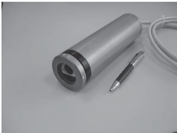
Рис. 1. Внешний вид лазерного доплеровского датчика ЛД-03
