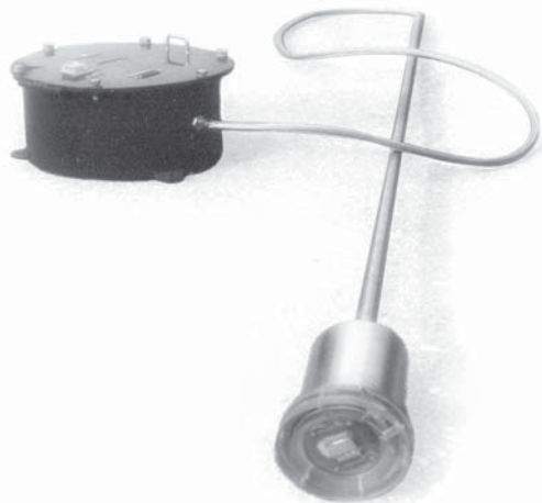
Рис. 1. Внешний вид СТД-измерителя уровня моря ИУМ-1
