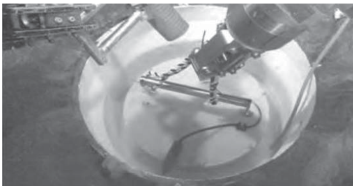
Рис. 8. Установка на дно сейсмографа МОВВ с помощью подводного робота
