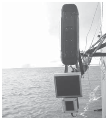
Рис. 1. Штанга с антеннами ГБО (сверху), эхолота-профилографа ( в середине) и многолучевого эхолота (внизу) в походном положении
