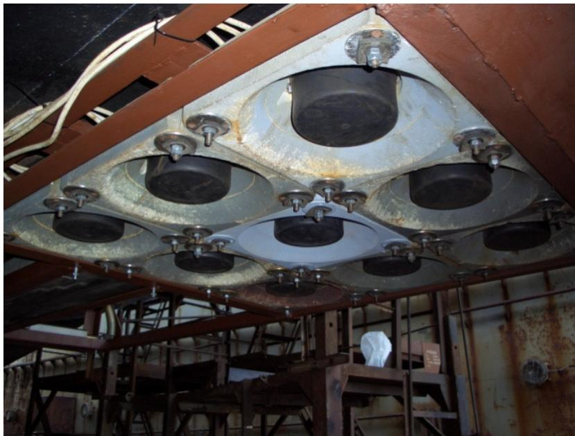
Рис. 5. Акустическая антенна эхолота-профилографа.
