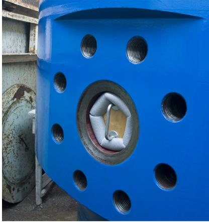
Илл. 65-2. Отверстие во фланце камеры с резьбовыми отверстиями для ввода в камеры гидравлических, электрических и пневматических магистралей для обеспечения функционирования испытываемого оборудования и измерительных приборов.
