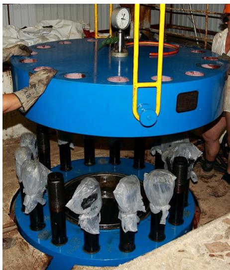
Илл. 1-10. Фланец тест-камеры со шпильками и крышка перед закрытием.
