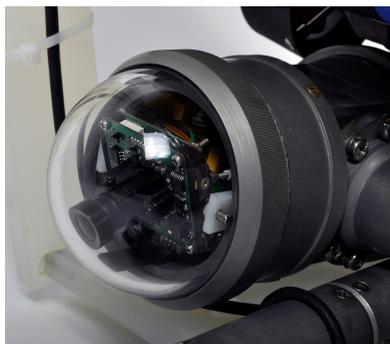
Илл. 42-2. Видеокамера с сервоприводом наклона.
