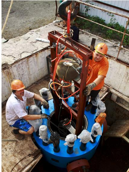
Илл. 65-3. Спуск в камеру пространственной рамы с закрепленными на ней испытываемыми элементами движительно-рулевого комплекса АСА «Бестер».
