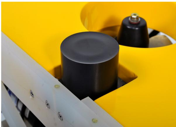
Рис. 4. Маяк гидроакустической навигационной системы TrackLink.
