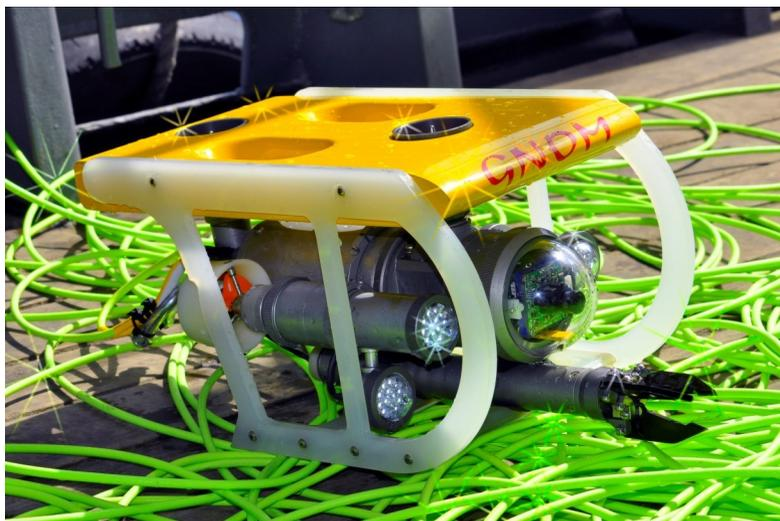
Илл. 1-7. Базовая модель подводного телеуправляемого аппарата класса мини ГНОМ «Супер».
