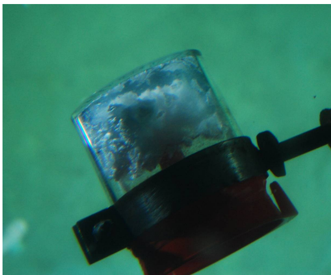
Илл. 35-3. Гидратная пена в ловушке «Воронка», образовавшаяся из метановых пузырей на глубине 1400 метров.
