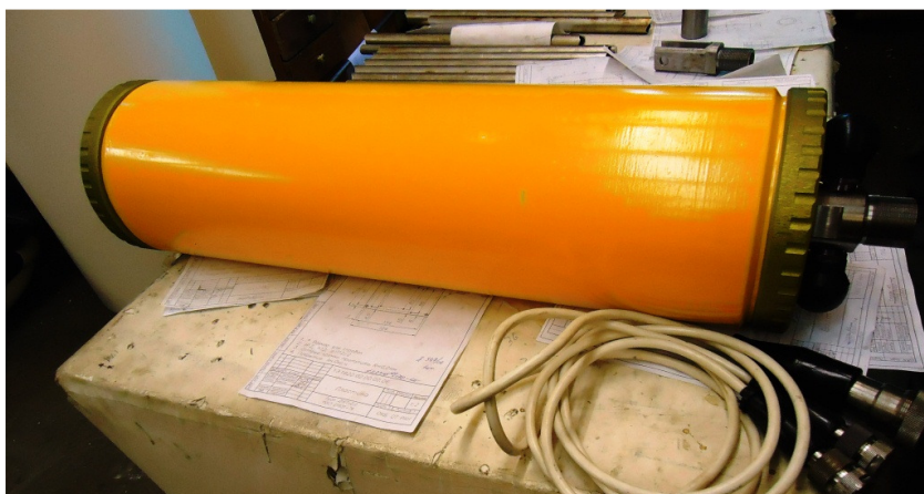
Илл. 29-2. Внешний вид измерительного блока широкополосного донного сейсмографа ШАДС-К.
