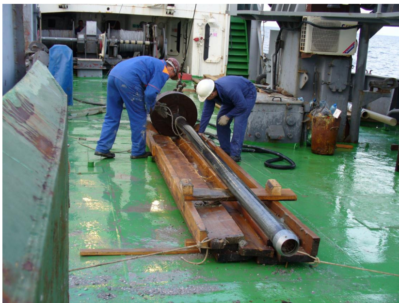
Рис.1. Облегченный гравитационный пробоотборник калибра 112мм.
