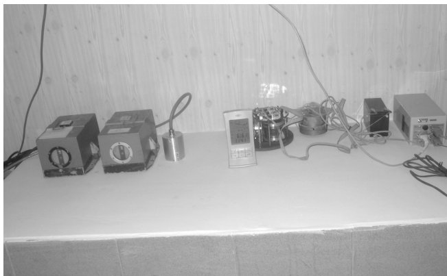
Рис. 1. Испытательный сейсмологический стенд в подземном бункере на территории ОКБ ОТ РАН
