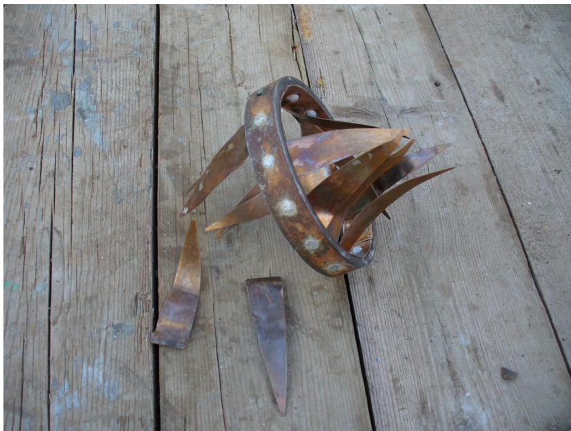
Рис. 2. Лестковый кернорватель поврежденный при работе на консолидированных глинах.
