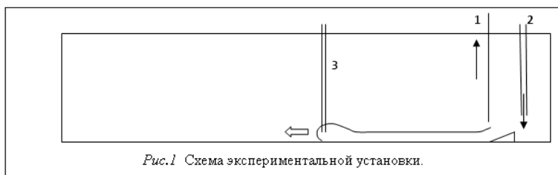
Рис. 1. Схема лабораторной установки. 1- подвижная пластина, 2- подводящий шланг, 3 – отбор проб воды на солёность.
