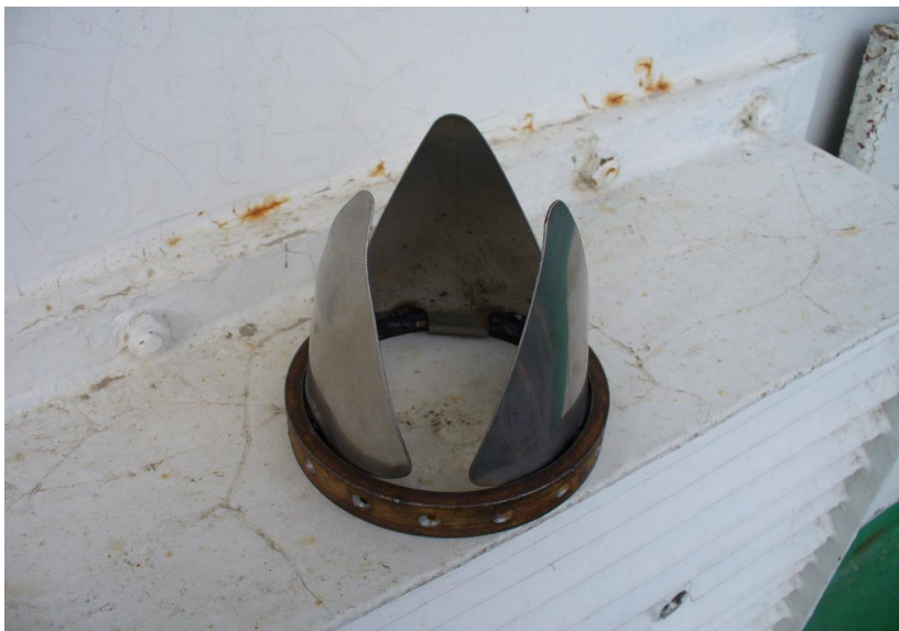
Рис. 3. Опытный образец kernорвательного устройства для работы с тяжелыми грунтами.
