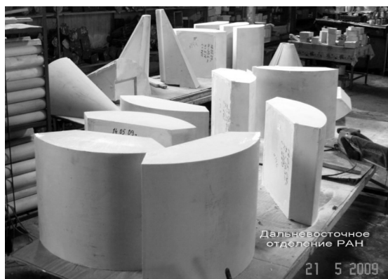
Рис. 2 Комплект блоков плавучестей для оснащения ПТС.
