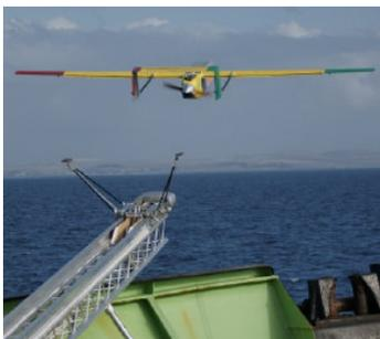
Рис. 5. Посадка БПЛА NOC на судно с помощью палубного взлетно-посадочного устройства в ходе испытаний в феврале 2008 г. БПЛА NOC: дальность более 300 км, полезная нагрузка 2 кг.
