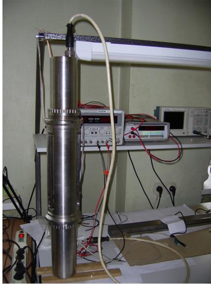
Рис. 6 Макет измерительного канала показателя ослабления направленного света на лабораторном стенде.
