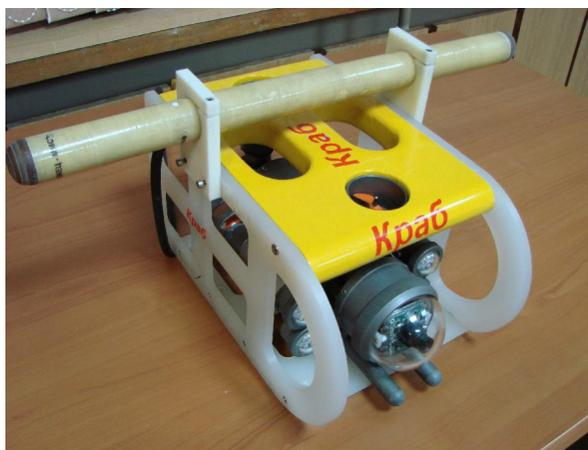
Рис. 1. Внешний вид ПМА с бортовым магнитометром.
