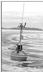
получения подобной информации. Один вариант – это использование якорных буев с несколькими (например, 2-5) точечными датчиками течения, установленными под бумом на кабеле, и с метеорологическими датчиками над поверхностью. Эти буи обычно располагаются на подходах к портам и служат для предоставления информации судоводителям. Если измерения течения требуются на
