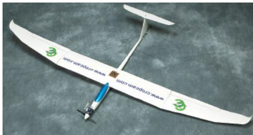
Рис. 6. БПЛА фирмы StopCam. Длина фюзеляжа 1.2 м, размах крыльев 2.4 м, вес 2.7 кг, запаса хода 20 мин, высота полета 120-700 м, разрешение 15 см с высоты 700 м.
