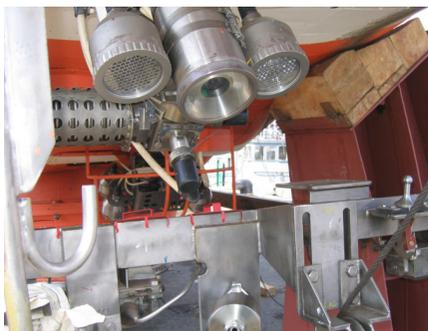
Рис. 5 Поворотный видеомодуль
