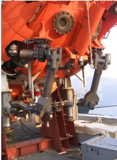
Рис.1. Исполнительные органы, установленные на ПА
