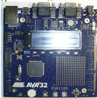
Рис. 3. Внешний вид одноплатной системы центрального контроллера.
