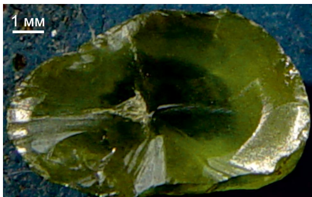
Рис. 3. Индукционные поверхности на сколе через центр зерна демантоида. Каркодинское м-е, Ср. Урал. Фото А.Ю. Кисина
