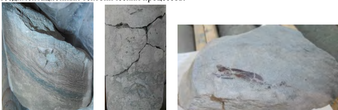
Рис.4. Диагностические признаки обстановки седиментации в керне – интракласты, системы трещин, включения фауны (Жуковская Е.А., ОАО «Газпромнефть-НТЦ», 2015)
