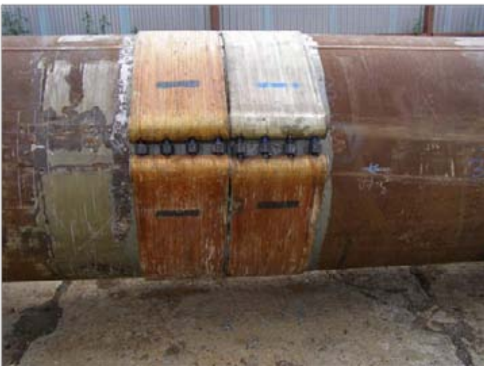
Рис. 2. Трубный образец с двумя плотно установленными муфтами
