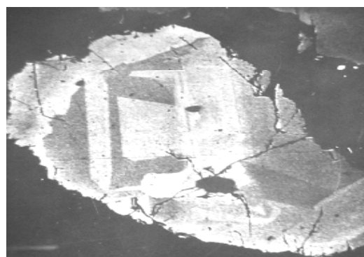
Fig. 6. Recrystallized eudialyte. 200μm.
