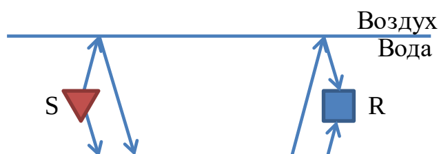
Рис. 1. Схема образования полезных волн и волн-спутников (S – источник, R – приёмник).
