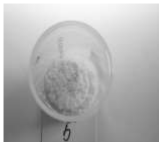
Рис. 1. Внешний вид полученных образцов после отверждения жидких органических отходов.
