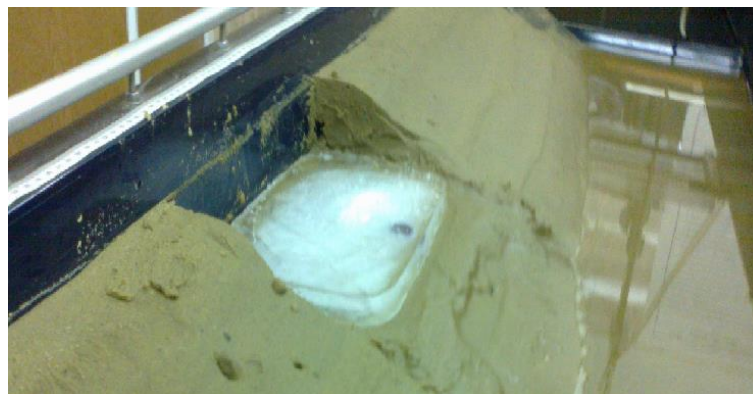
Рис. 3. Закладка ледяной пластины с пятном примеси в береговой откос при проведении лабораторного эксперимента
