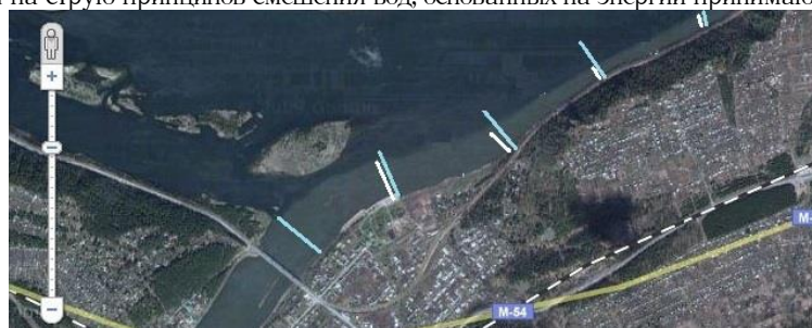
Рис. 4. Ширина струи притока Мана и ширина расчётной области турбулентной диффузии в р. Енисее. Струя попадает в зону смешения по Тэйлору, но не смешивается, а сохраняется на расстоянии десятков км от начала (Google).
