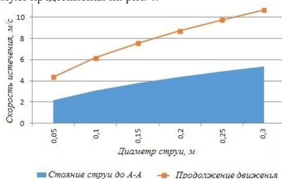
Рис. 6. Скорости истечения, не обеспечивающие преодоление расстояния до переходного сечения (закрашено) и скорости, обеспечивающие продолжение струи далее сечения
